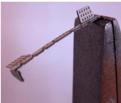
Geben sie nur sehr wenig Kleber oder Lötpaste in die Aussparungen in der Pufferbohle und löten diese fest. Es hilft, wenn man den Wagen auf dem Kopf auf eine flache Unterlage legt.
